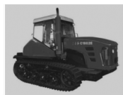
拖拉机装有宽大的履带
