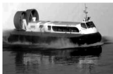
气垫船向下喷气,使船体被抬升
