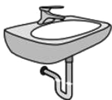
排水管装有 U 形“反水弯”
